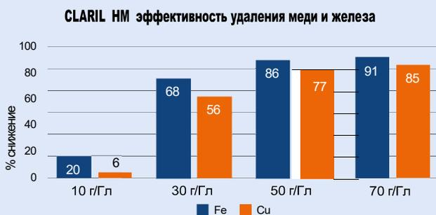
Рис. 4: Claril HM эффективно снижает содержание меди и железа в вине, предотвращая окисление и помутнение. Сочетание PVI/PVP и хитозана способствует усилению его действия по удалению железа.
