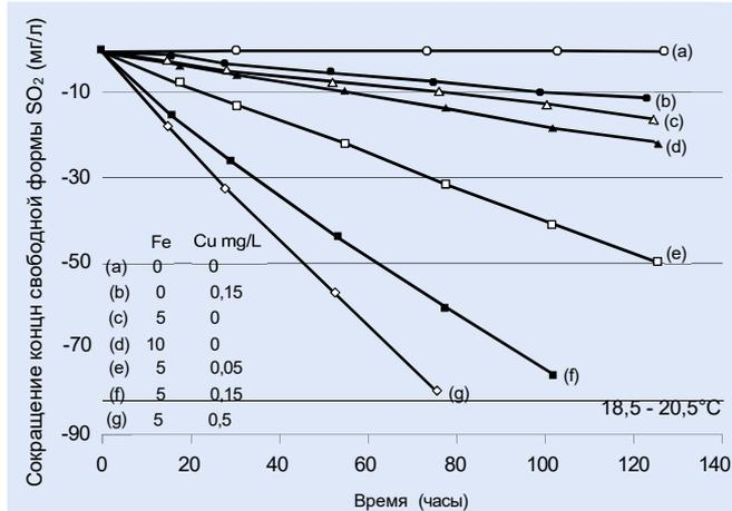
Рис. 3: Значение меди и железа в окислении вина (по Данилевичу, 2007). В то время как воздействие кислорода на модельный раствор вина не вызывает окисления свободного  $SO_2$  (линия а), добавление меди и железа (линии е, f и g) приводит к быстрому снижению свободного  $SO_2$ . Два металла вместе дают большее снижение, чем сумма скоростей, наблюдаемых при их тестировании по отдельности (линии b, c и d)
