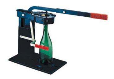
**3.** Ручная укупорка РЕГИНА для шампанской пробки. Для шампанской пробки - аггломерат с двумя фасками Ø 29 мм - высота 47 мм, для шампанской пробки с двумя дисками Ø 30,5 мм - высота 47 мм. Бутылка - Ø макс.110 мм, высота 230-390 мм. Сжатие пробки - до 17 мм. Италия
