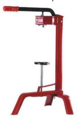
**2.** Ручная настольная укупорка **Zenit**. Для винной пробки Ø max 30 мм, высота Бутылки - min/max 24/34 cm. Сжатие пробки - до 17 мм. Италия
