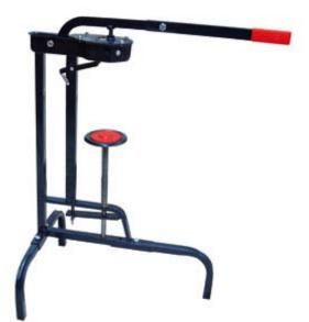
**4.** Ручная укупорка РЕГИНА для шампанской пробки. **Хромированые кулачки.** Для шампанской пробки -аггломерат с двумя фасками Ø 29 мм - высота 47 мм, для шампанской пробки с двумя дисками Ø 30,5 мм - высота 47 мм. Бутылка - Ø макс.110 мм, высота 230-390 мм. Сжатие пробки - до 17 мм. Италия
